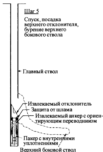
Рис. 1.52. Многоствольное заканчивание, шаг 5. Спуск, посадка верхнего отклонителя, бурение верхнего бокового ствола
