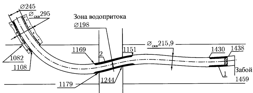
Рис. 1.32. Технологическая схема изоляции водопритоков в горизонтальных стволах с помощью перекрывателей
