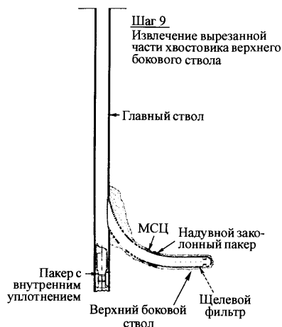
Рис. 1.56. Многоствольное заканчивание скважины, шаг 9. Извлечение вырезанной части хвостовика верхнего бокового ствола
