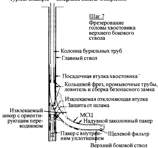
Рис. 1.54. Многоствольное заканчивание, шаг 7. Фрезерование головы хвостовика верхнего бокового ствола
