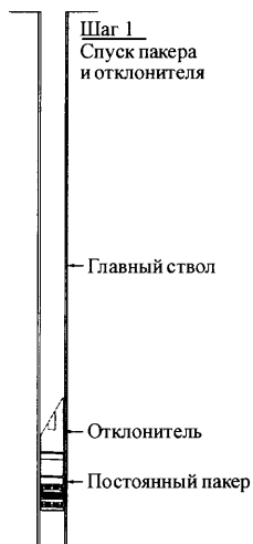
Рис. 1.48. Спуск пакера и отклонителя, шаг 1
